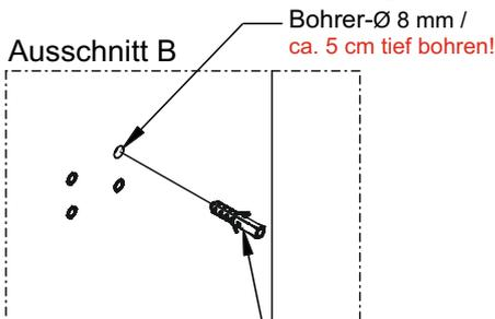
Abb. 12 - Anzeichnen, Bohren und Dübeln für die Wandklammern
