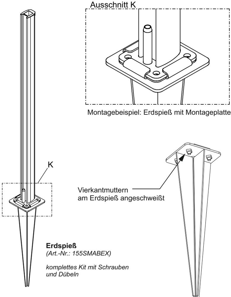
Abb. 25 - Anwendung des optional erhältlichen Erdspeiß
