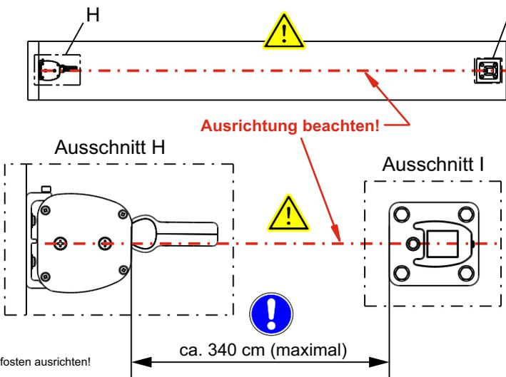
Abb. 16 - Haltepfosten ausrichten!
