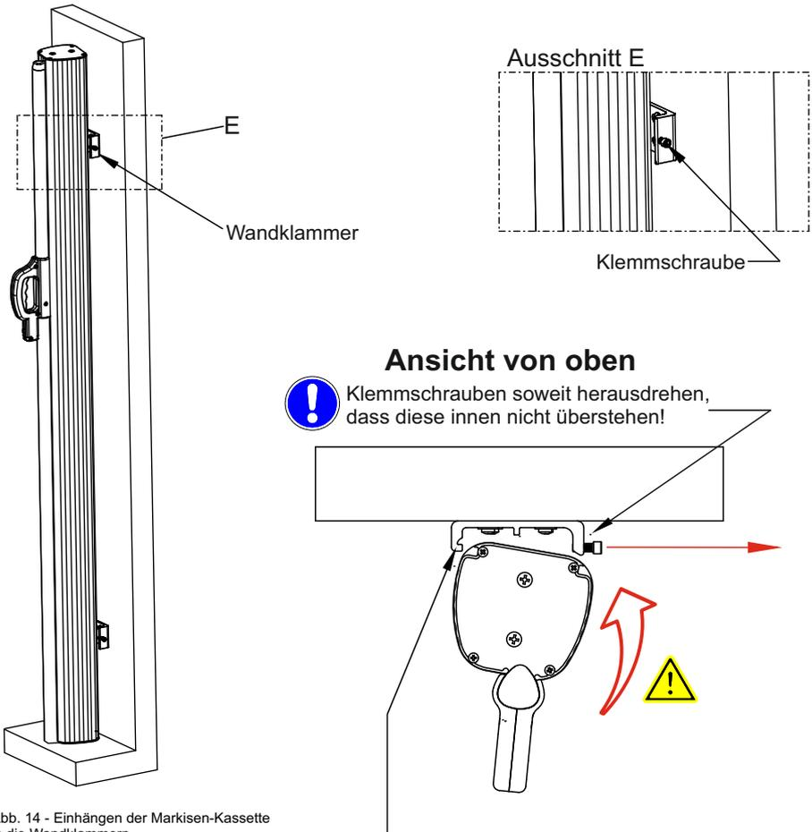
Abb. 14 - Einhängen der Markisen-Kassette in die Wandklammern
