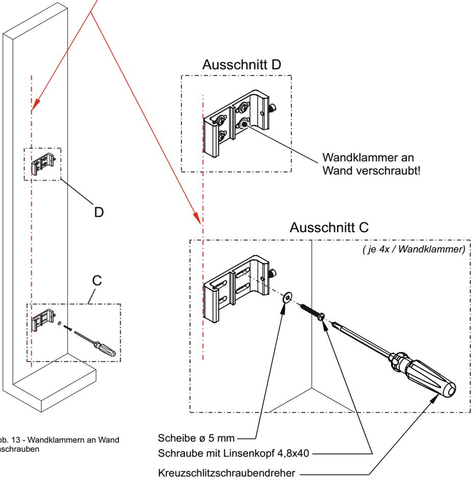
Abb. 13 - Wandklammern an Wand anschrauben
