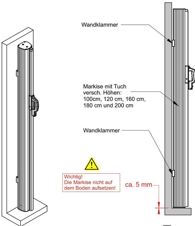
Abb. 10 - montierte Markisen-Kassette
